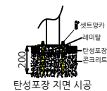
탄성포장 지면 시공
